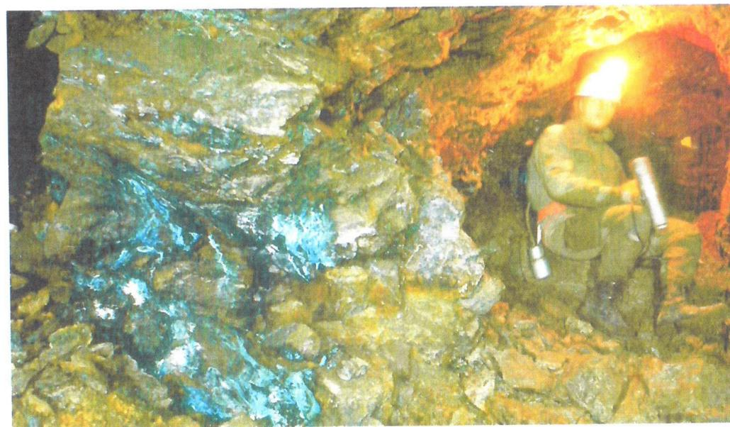
Allophane vivement coloré en bleu par des traces de cuivre sur une fahlbande dans la mine de Grand Praz. La radioactivité des roches est mesurée au moyen d'un scintillomètre.
