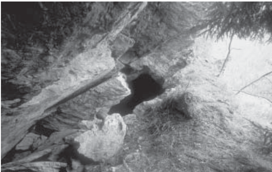
Photo 16: Entrée des travaux à ciel ouvert de la mine de cobalt-nickel de Grand-Praz, au sud d'Ayer. C'est à cet endroit qu'une grosse lentille de minerai affleurerait et qu'elle a été entièrement exploitée à la fin du 18ème siècle. Cette entrée permet toujours l'accès aux travaux inférieurs et supérieurs de la mine (août 2001). Photo: Stefan Ansemet
