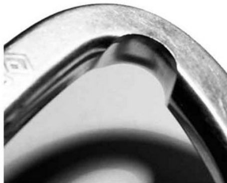
À gauche : mousqueton tranchant © Black Diamond - À droite : maillon fragilisé et tranchant.
